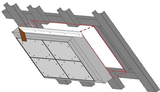
Controllate la misura dell'apertura sulla struttura a soffitto e della botola Jumbo. (misura del telaio esterno + 5 mm)
