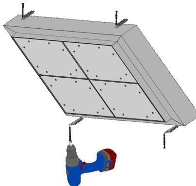
Fissate sul telaio esterno della botola Jumbo per soffitto le staffe.
