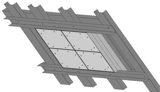
Inserite la botola Jumbo per soffitto sull'ausilio di montaggio e controllate il corretto posizionamento.
