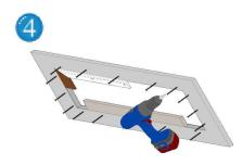
Premete il telaio esterno contro la parete dal retro e fissatelo al soffitto di gesso rivestito con viti autofilettanti ad una distanza massima tra loro di 17 cm.
