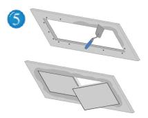
Stuccate ora il contorno del telaio esterno al soffitto di gesso rivestito, incluse le viti.
