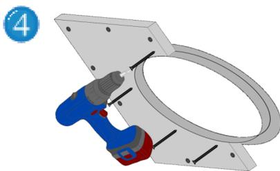
Togliete lo sportello dal telaio esterno e montatelo nel taglio fatto a parete o soffitto. Per applicazione a parete fate attenzione alla direzione di apertura: i click clack devono trovarsi sulla parte superiore. Premete il telaio esterno contro la parete dal retro e fissatelo con viti autofilettanti.
