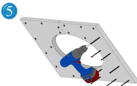
Fissate anche la seconda parte della lastra di cartongesso, avvitando anche la seconda parte del telaio.
