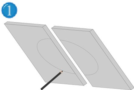
Disegnate il contorno del telaio esterno sulle lastre che andranno montate a soffitto o parete, in modo che metà della botola sia su una metà e metà sull'altra.
