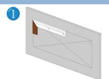
Misurate il telaio esterno e con l'ausilio di una falsa squadra disegnate il profilo dell'apertura sulla parete in cui andrà collocata la botola.
