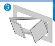
Prendete la botola d'ispezione e facendola ruotare inserita in diagonale attraverso l'apertura praticata.
