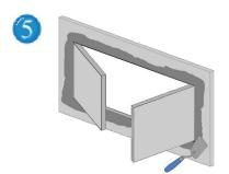
Stuccate ora il contorno del telaio esterno alla parete di gesso rivestito, incluse le viti.
