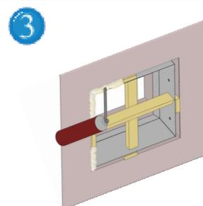
Inserite nella fessura tra il telaio e la muratura la schiuma poliuretanicca e lasciatela asciugare per il tempo indicato sulle istruzioni fornite dal produttore.
