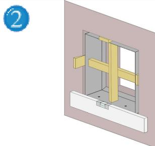
Prendete il telaio della botola e inseritelo nel foro. Con l'aiuto di una livella a bolla, puntate il telaio, fissatelo con dei cunei e inserite dei traversi orizzontali e verticali. Fate attenzione alla direzione di apertura a seconda di come deve aprirsi lo sportello lateralmente.
