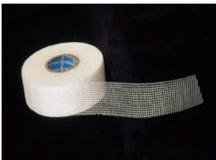
Il **nastro in fibra di vetro**, per l'utilizzo sui giunti di speciali lastre in gesso rivestito con tessuto non-tessuto in fibra di vetro (lastre Fireboard® in classe 0 ad elevata resistenza al fuoco), può essere talvolta utilizzato anche sulle lastre in gesso rivestito con cartone.
