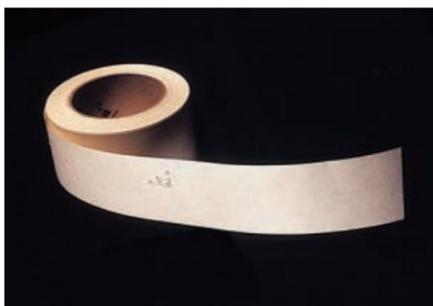
Il **nastro in rete autoadesiva** costituisce certamente il metodo più veloce e facile per armare i giunti. Costituito da una maglia ortogonale stretta in fibra minerale con una faccia adesiva che ne permette l'adesione diretta alla superficie cartonata delle lastre, evita la mano di fondo richiesta per il fissaggio del nastro in carta. Questo nastro riduce leggermente il tempo di esecuzione del giunto, ma offre una resistenza meccanica del giunto inferiore rispetto alla stuccatura con carta.
