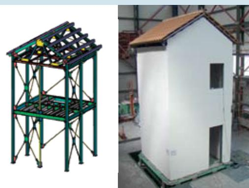
Una costruzione leggera completa su due piani è stata fabbricata utilizzando pareti esterne realizzate con Knauf Aquapanel® su una struttura in acciaio.
