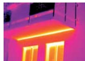
La perdita di isolamento della finestra porta alla perdita di energia. Il resto della facciata è sufficientemente isolata.
