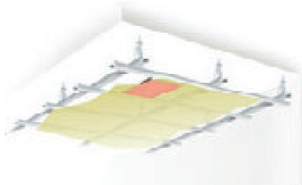
Figura A - Botola antincendio
