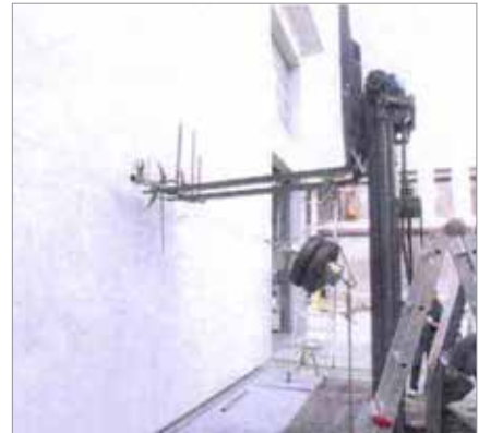
Test di resistenza all'urto, riferimento EN 12600 con 50kg
